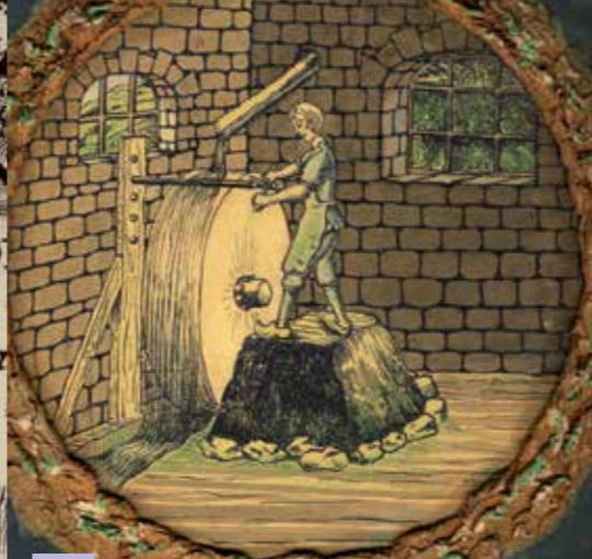
Meulage des canons grâce à la force motrice du Furan.
